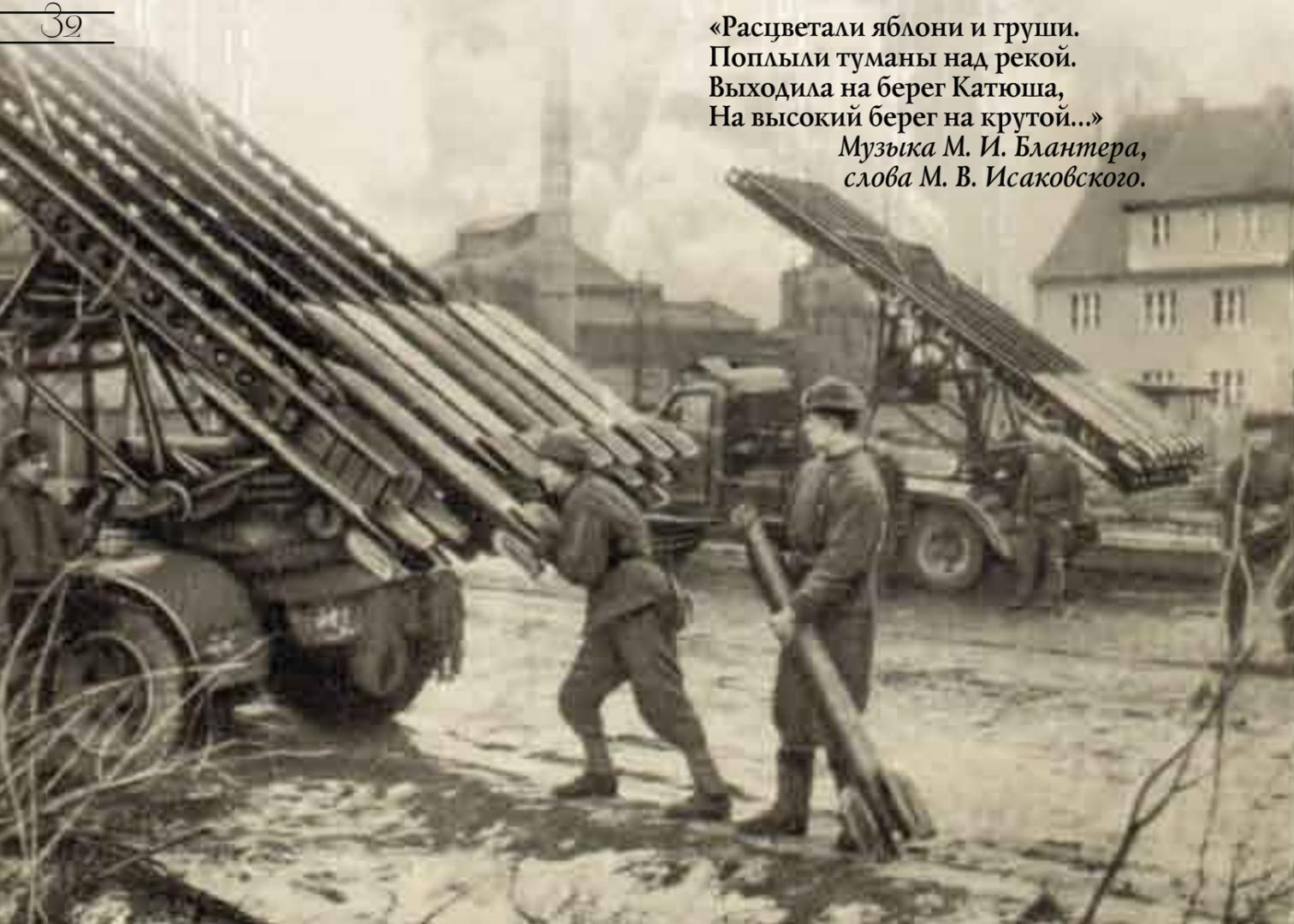
В 1938–1941 годах в РНИИ совместно с И.И. Гваем, В.Н. Галковским, А.П. Павленко, А.С. Поповым и другими была создана многозарядная пусковая установка, смонтированная на грузовом автомобиле РС-М13, и пусковая установка БМ-13. Они обе были приняты на вооружение артиллерии накануне Великой Отечественной войны.
